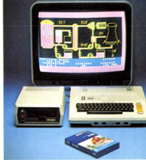
Un système comprend : l'unité centrale (ici Atari 400) ; un lecteur de programme, un écran de télévision et le programme.
